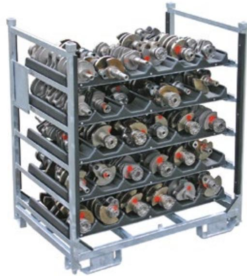
*Sonderladungsträger für Kurbelwellen auf antirutschbeschichteten Kunststofftrays*
