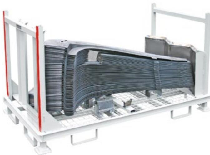
*Robotergestell für A-, B- oder C-Säulen*
