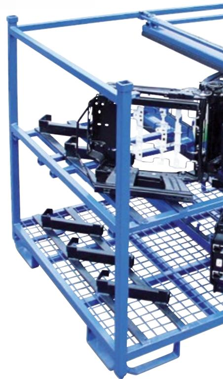
FEIL Rungenpaletten sind mehrfach stapelbare Ladungsträger, mit denen sich modular und auf kostensparende Weise bedarfsgerechte Blocklager realisieren lassen. Verwindungssteife Basiseinheiten und Einsteckrohre in den verschiedenen Längen garantieren eine optimale Flächen- und Höhennutzung, wobei Anpassungen an veränderte Anforderungen später noch problemlos möglich sind.
