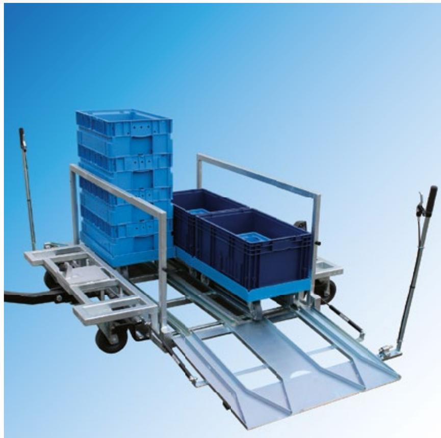
Ein Routenzugsystem ist ein Transportkonzept, das verschiedene Bereitstellorte und Verbrauchsstellen in einer Produktionsstätte durch Routen verbindet. Entlang der zumeist festen Routen können mit Routenzügen (Zugmaschine plus Anhänger) in entsprechenden Zyklen Teile und Materialien mit jeder Fahrt sowohl verteilt als auch eingesammelt werden. So lässt sich der Zeit- und Energieaufwand für die Transportfahrten minimieren und zugleich die Produktivität optimieren.
